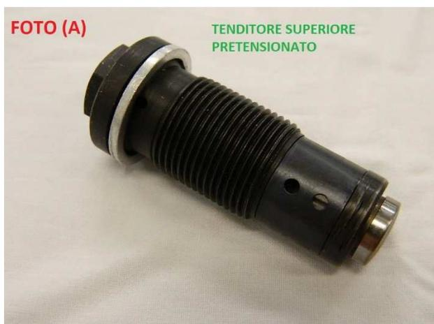
Durante la procedura di rimontaggio seguire attentamente tutte le fasi fino ad arrivare al montaggio del tenditore superiore che deve essere montato **senza essere sbloccato.**
