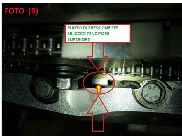
**ATTENZIONE: in caso di azionamento accidentale del tenditore idraulico è obbligatorio sostituirlo con uno nuovo, non è possibile riportare il pistone nella posizione iniziale, poiché questo verrebbe irreparabilmente danneggiato.**
